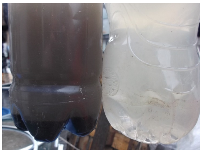
Рисунок 10. Образцы проб оборотной воды и фильтрата после сепарации. (фото автора).
