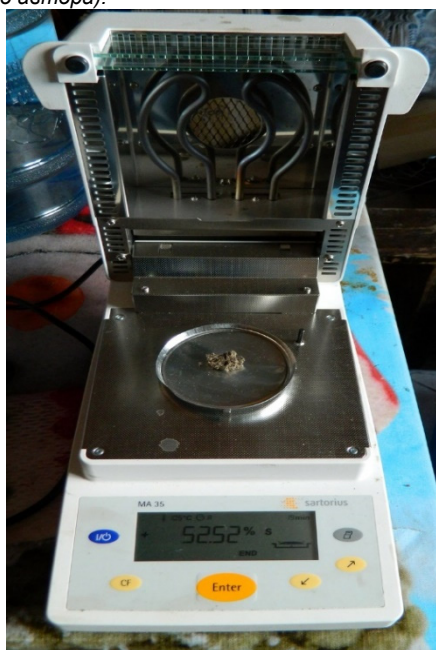
Рисунок 7. Измерения влажности обезвоженной твердой фазы после сепарации. (фото автора).
