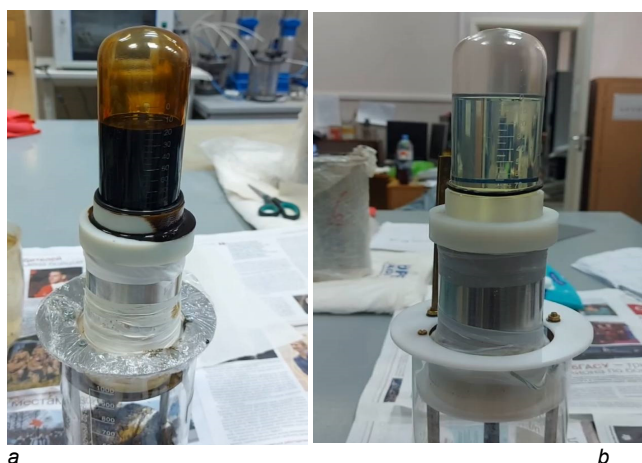
Рис. 3. Прибор КФ-1 в процессе определения скорости инфильтрации тяжелой нефти (а) и дизельного топлива (б) в песчаный грунт.
