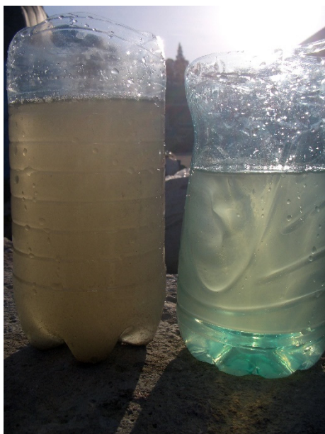
Рисунок 12. Образцы проб оборотной воды, обезвоженной фазы и фильтрата после сепарации. (фото автора).
