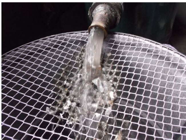
Рисунок 3. Сетка перед подачей оборотной воды в центрифугу. (фото автора).
