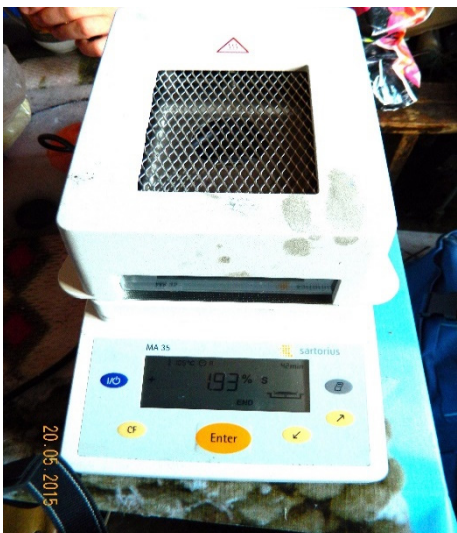
Рисунок 6. Измерения влажности оборотной воды до сепарации. (фото автора).
