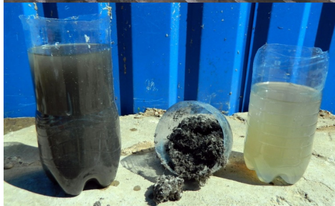
Рисунок 8. Образцы проб оборотной воды, обезвоженной фазы и фильтрата после сепарации. (фото автора).
