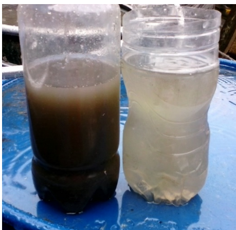
Рисунок 13. Образцы проб оборотной воды и фильтрата после сепарации. (фото автора).
